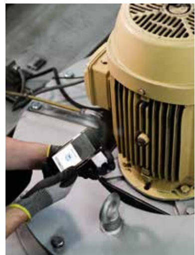
Activation et intégration du capteur à l'aide de l'application Schaeffler OPTIME
