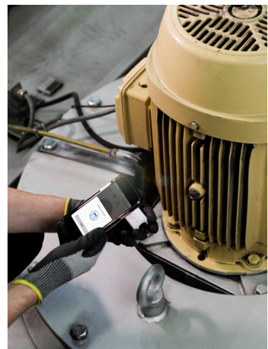
Sensor mithilfe der Schaeffler Optime App aktivieren und einbinden.
