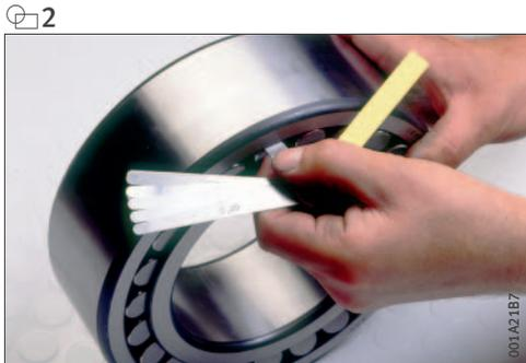
测量后，必须记录径向内部游隙的值  $s_r$  ③。
