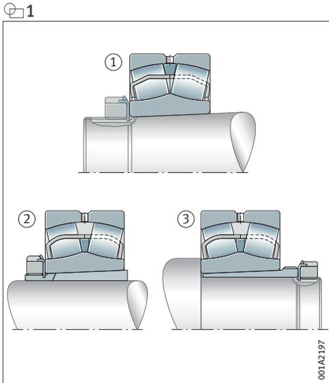
在安装调心滚子轴承前，使用塞尺测量两排滚子的径向内部游隙 ②。重要的是，在测量过程中，外圈和内圈要彼此相对居中，调心滚子轴承内的滚子要排列得当。例如，可通过多次旋转调心滚子轴承来达到以上要求。
