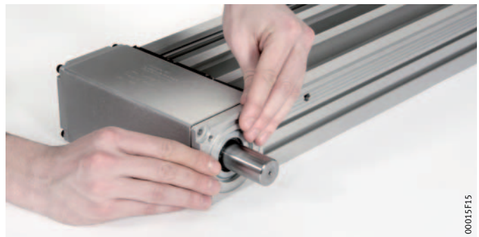
Figura 12 Extraer la tapa del rodamiento
