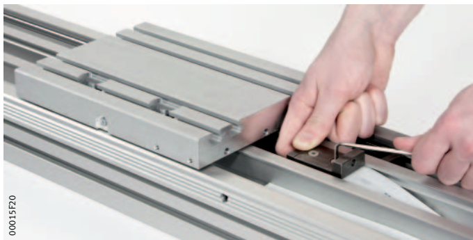
Figura 29 Atornillar los dispositivos tensores a las correas dentadas
