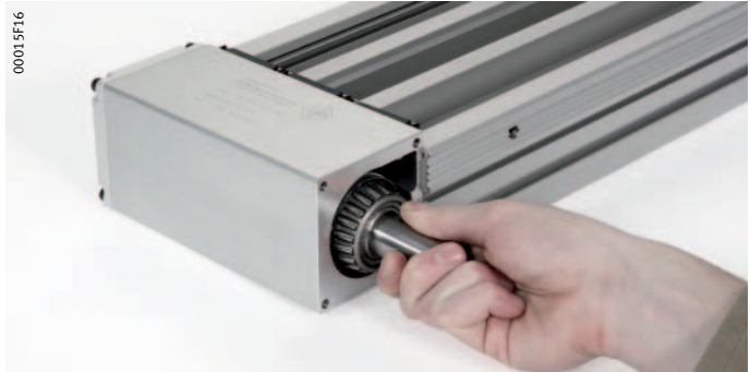
Figura 13 Extraer la polea dentada
