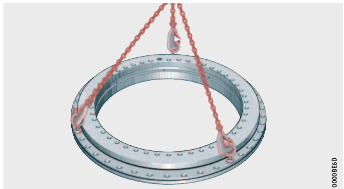
図 5 ホイストとアイボルトを 使用した運搬
