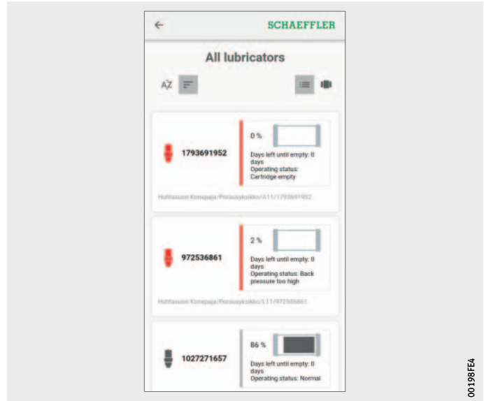
Bild 43 Schmierstoffgeber mit leerer Kartusche
