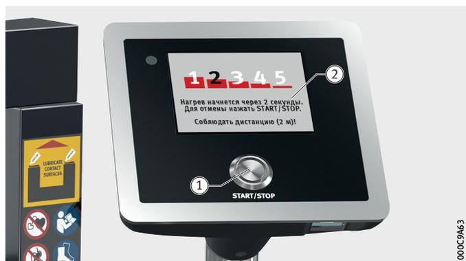
По истечении времени обратного отсчета создается электромагнитное поле, и подшипник качения нагревается.
