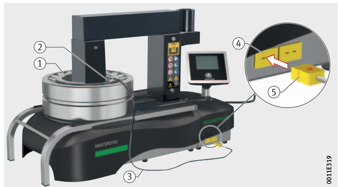
Figura 41 Conectando e afixando os sensores de temperatura
