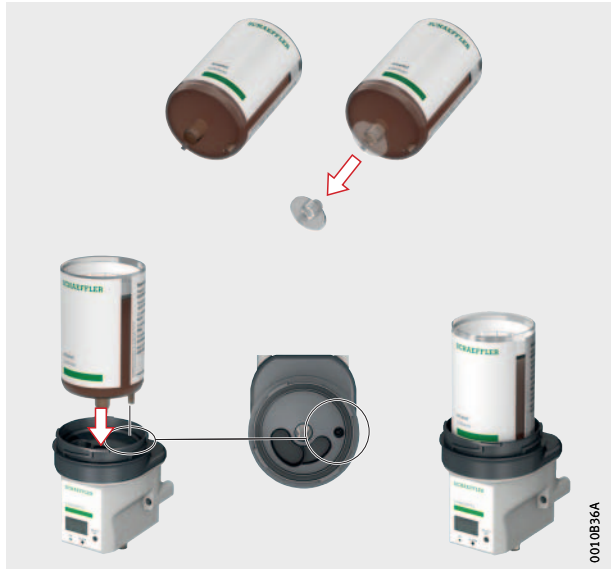
Figura 10 Insertar el cartucho de grasa
