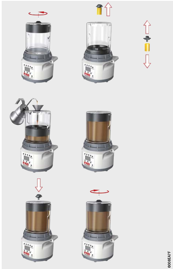
Bild 10 Füllen des Ölerservoirs
