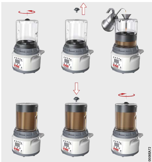
Bild 60 Ölreservoir wiederbefüllen
