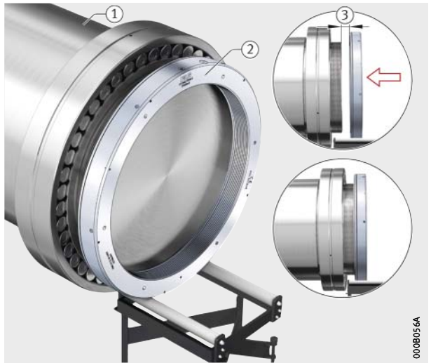
Bilde 19 Skyve den hydrauliske mutteren
