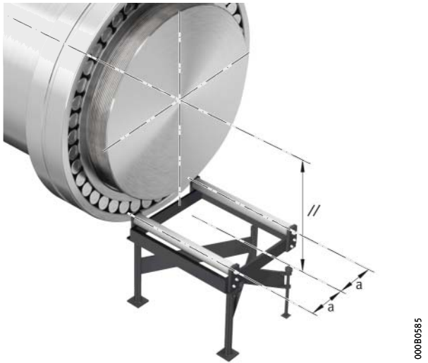
Bilde 16 Rette inn monteringshjelpemiddel
