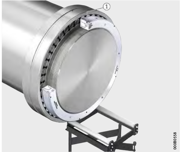
Figura 21 Leggero allentamento della ghiera idraulica
