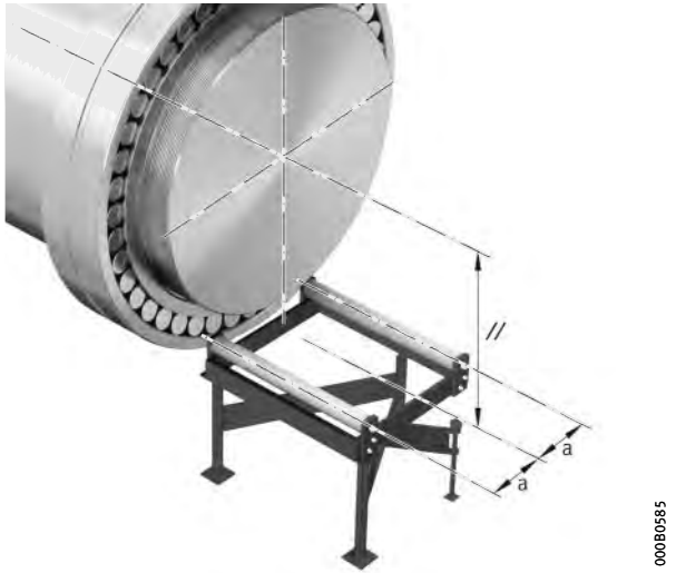
Figura 16 Allineamento dell'attrezzo di montaggio
