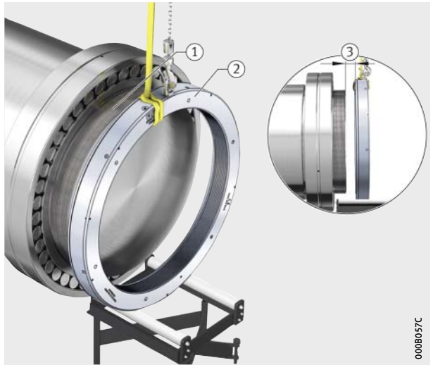
Figura 17 Colocación de la tuerca hidráulica
