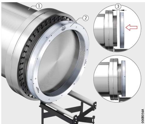
Figura 19 Desplazamiento de la tuerca hidráulica
