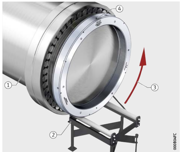
Figura 35 Desenroscado de la tuerca hidráulica
