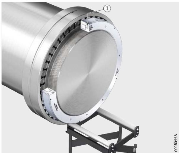
Figur 21 Løsn den hydrauliske møtrik en smule
