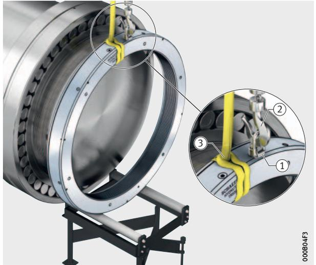
► Hydraulikmutter stoß- und schwingungsfrei transportieren, Bild 37.
