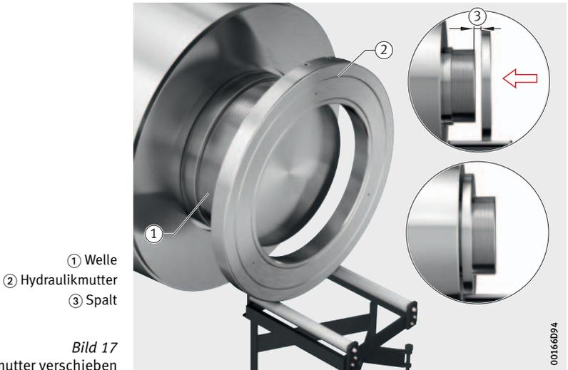
Eine Gewindebohrung G<sup>1/4</sup> muss sich oben befinden und zwischen Hydraulikmutter und Befestigungsmutter beziehungsweise Scheibe darf kein Spalt sein:
