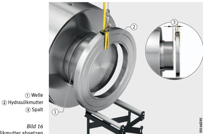
► Sicherungsgurt entfernen.
