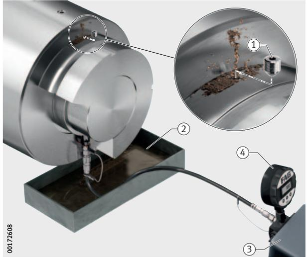
**Bauteil aufpressen** Beim Aufpressen kann mit oder ohne Druckölverfahren gearbeitet werden. Das Druckölverfahren wird im Montagehandbuch MH 1 erklärt.
