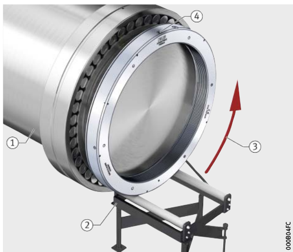
Figura 35 Desaparafusamento da porca hidráulica
