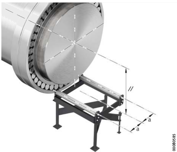
Figura 16 Alinhamento do auxiliar de montagem
