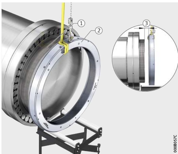
Figura 17 Colocação da porca hidráulica no auxiliar de montagem
