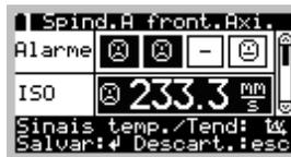
Na linha "Alarme" é mostrada uma visão geral do status de alarme de todos os valores característicos. Se existir mais de um valor característico, é exibida uma barra de rolagem à direita no display. Valores característicos cujos limiares de alarme principal foram excedidos são mostrados em fundo vermelho.
