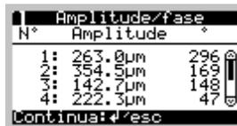
Você pode repetir uma medição (totalmente ou em pontos de medição isolados) antes de transmitir os dados medidos ao software Trendline. Para isto, selecione **Repetir medição** no menu **Amplitude/fase**. O Detector exibe uma tabela com todos os pontos de medição existentes. Um ponto de medição, que já foi medido, é identificado na tabela com o símbolo **■**. Selecione o ponto de
