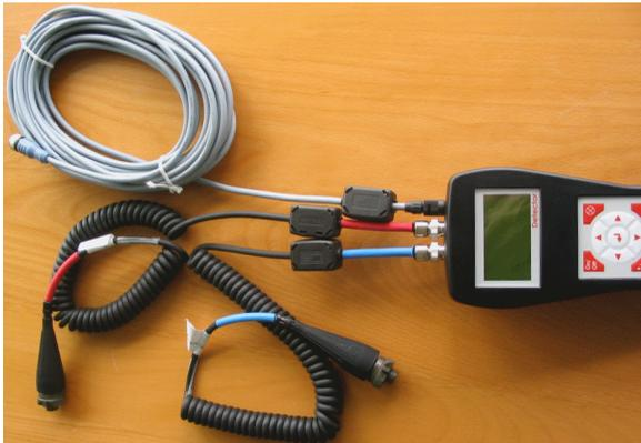
*Ferrites fixados nos cabos de sensores*
