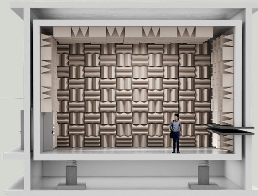
Völlig losgelöst: Um den Messraum von Körperschall und anderen Einflüssen zu entkoppeln, hat er bis auf die Federn, auf denen er steht, keine Berührung mit anderen Gebäudeteilen
