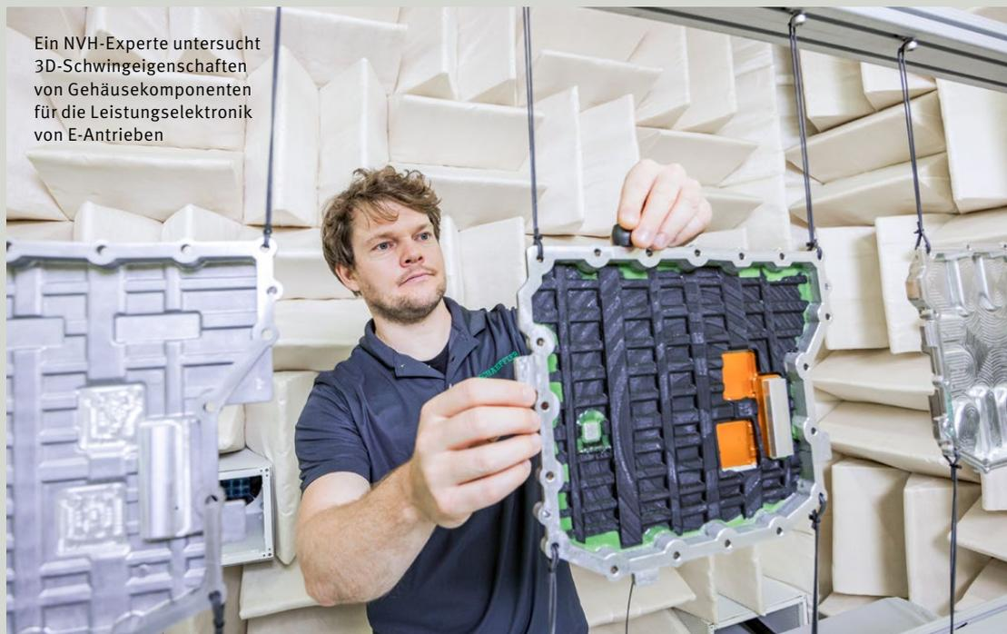
Ein NVH-Experte untersucht 3D-Schwingeeigenschaften von Gehäusekomponenten für die Leistungselektronik von E-Antrieben
