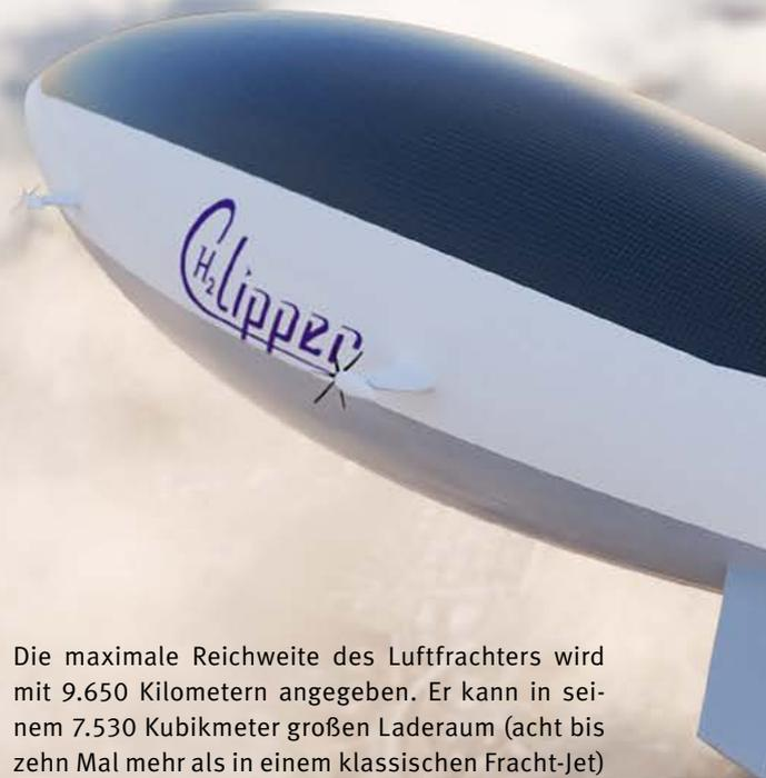
Die maximale Reichweite des Luftfrachters wird mit 9.650 Kilometern angegeben. Er kann in seinem 7.530 Kubikmeter großen Laderaum (acht bis zehn Mal mehr als in einem klassischen Fracht-Jet) Lasten von bis zu 150 Tonnen transportieren. Die Frachtkosten von 0,177 bis 0,247 US-Dollar pro Tonnenmeile liegen bei einem Viertel im Vergleich zur klassischen Luftfracht, aber über denen von Lkw (0,12) Bahn (0,04) und Seeweg (0,01).
