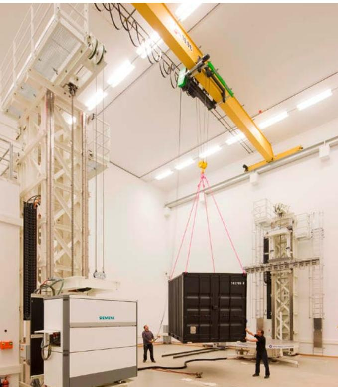
Das XXL-CT-System besteht im Wesentlichen aus einem Linearbeschleuniger (l.), einem präzisen Drehteller und einem Zeilendetektor (r.)
