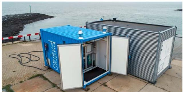
Die Pilotanlage zur Herstellung von Wasserstoff aus Meerwasser auf der niederländischen Insel Texel. In ähnlicher Bauweise könnte diese in wenigen Jahren in Offshore-Windparks zum Einsatz kommen
