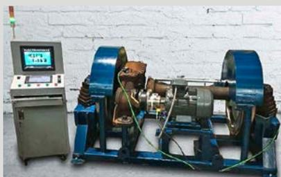
Der Condition-Monitoring-Prüfstand nimmt komplette Bahnradsätze auf
