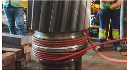
Mittels eines Induktors wird der Lagerinnenring auf der Welle erwärmt und die Demontage erleichtert
