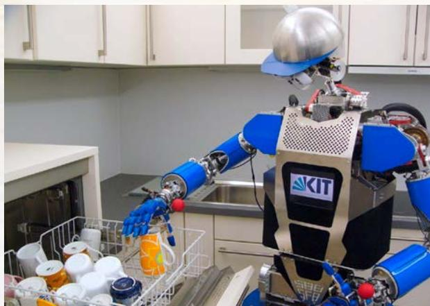
Die am Karlsruher Institut für Technologie (KIT) entwickelten ARMAR-Roboter führen komplexe Aufgaben in einer Küchenumgebung aus, lernen von Menschen und interagieren mit ihnen mithilfe von natürlicher Sprache
