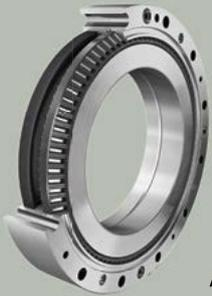
Das innovative Schrägnadellager hat gegenüber den bisher für die Gelenkarmlagerung eingesetzten Kreuzrollenlagern eine erhöhte Anzahl tragender Wälzkörper – bei gleichbleibender Baugröße. Der Kunde kann für seine Anwendung kleinere Lagergrößen wählen, spart dadurch Bauraum und Gewicht. Es ergeben sich
