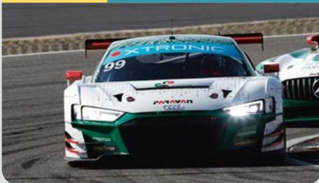
Im Rahmen des 24h-Rennens auf dem Nürburgring präsentiert Schaeffler Paravan einen **Audi R8 LMS** mit der Steer-by-Wire-Technologie Space Drive – den ersten Rennwagen ohne Lenksäule. Weitere Rennautos und -einsätze folgen. Die dort gesammelten Erfahrungen unterstützen die Entwicklung des aus der Behindertenmobilität kommenden Systems. Space Drive ist eine Schlüsseltechnologie für automatisiertes und vernetztes Fahren.
