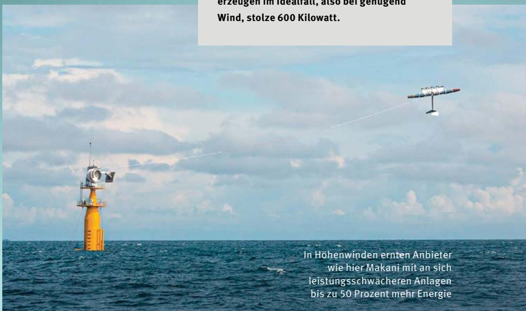
In Höhenwinden ernten Anbieter wie hier Makani mit an sich leistungsschwächeren Anlagen bis zu 50 Prozent mehr Energie
