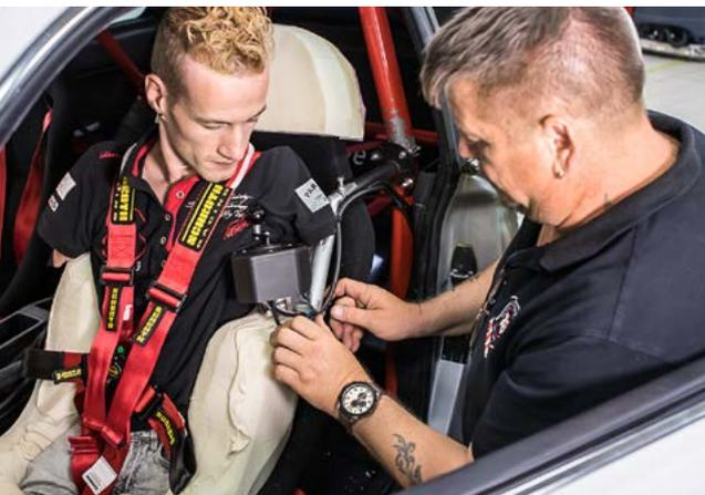
In einem speziell angepassten Sitz hat Janis McDavid den nötigen Halt im BMW M3. Mit dem Joystick unter der linken Achsel steuert er den Hightech-Renner
