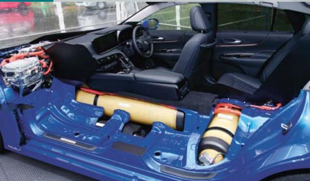
Die drei Tanks des neuen Toyota Mirai fassen 5,6 kg Wasserstoff. WLTP-Reichweite: 650 km. Beim Vorgänger waren es 500 km. Ebenfalls ein großer Fortschritt gegenüber dem Vorgänger: Die Bauzeit eines einzelnen Brennstoffzellen-Stacks reduzierte sich von 15 Minuten auf wenige Sekunden
