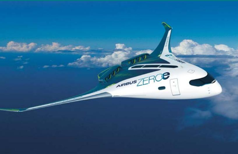
ZEROe ist ein Airbus-Konzeptflugzeug. Beim Nurflügler sorgen zwei Hybrid-Wasserstoff-Turbofan-Triebwerke für Schub. Die Flüssigwasserstoff-Speichertanks sind unter den Flügeln untergebracht
