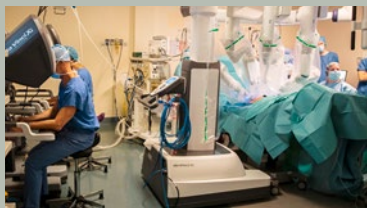
Die Operateure (links) bedienen die vier Arme des OP-Roboters mit Joysticks
