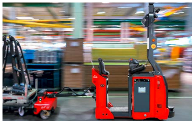
Autonomer Lieferant in der Werkshalle: Audi hat bereits 2017 mit dem Notfalltransport dringend benötigter Teile per Drohne experimentiert (oben). In vielen Produktions- und Lagerhallen fahren schon jetzt autonome Flurförderfahrzeuge des Gabelstapler- und Lagertechnikspezialisten Linde Material Handling (unten)
