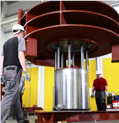
Montage eines großen Gehäuses mit montiertem Gelenklager für eine Offshore-Anlage
