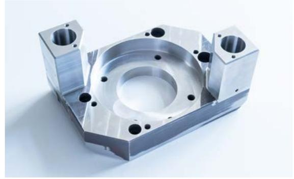
Für dieses Werkzeuggrundgestell einer Presse wurden in dem unten gezeigten 3D-Hybrid-Drucker von DMG Mori auf eine Grundplatte zwei Säulen im Pulverauftragsschweißverfahren „gedruckt“ und anschließend glatt gefräst
