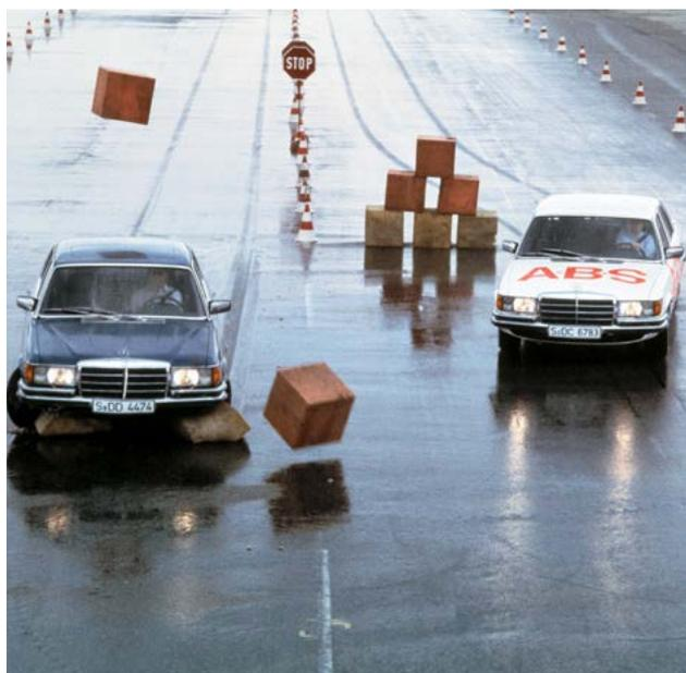
Bremsen, lösen, bremsen, lösen: Die 1978 von Mercedes in Großserie eingeführte automatische Stotterbremse ABS (Anti-Blockier-System) sorgt gerade bei rutschigen Verhältnissen für sicheres Verzögern
