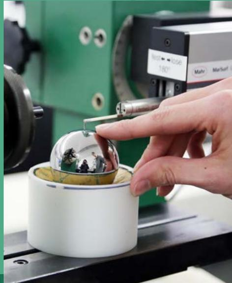
Die Triondur-C-beschichtete Schaeffler-Kugel mit einer Rundheit von 160 Nanometern
