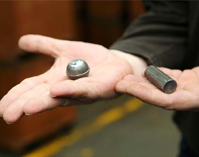
Früher wurden die Kugelrohlinge (l.) gegossen, heute dank modernster Fertigungsmethoden in Sekundenbruchteilen aus einem Metalldraht gepresst, der zuvor in kleine Stifte (r.) gestückelt wird
