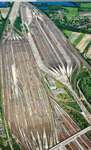
272 km Rangierwege, verteilt auf 64 Gleise in Süd-Nord- sowie 48 in Nord-Süd-Richtung, weist der größte Rangierbahnhof Europas in Maschen bei Hamburg (Foto) auf. Bis zu 3.500 Wagen können pro Tag auf einer Gesamtfläche von 700 Meter Breite und 7 km Länge abgefertigt werden. Maschen ist eine wichtige logistische Schlagader für die Millionenmetropole Hamburg und ihren Hafen. Noch gewaltiger ist nur der Bailey Yard in der geografischen Mitte der USA in Nebraska mit 507 Rangierkilometern.
