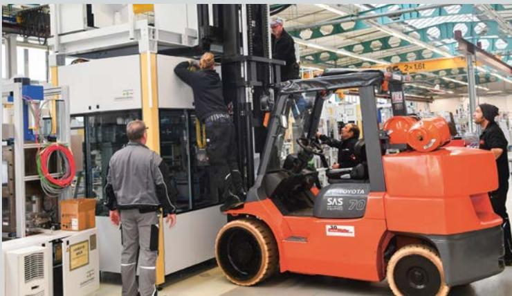
Die Produktionsanlage wird in einzelne Abschnitte geteilt (oben links). Bei der Demontage ist Fingerspitzengefühl gefragt, egal ob es um Schutzelemente oder Kabelstränge geht (oben rechts). Teamarbeit (Mitte links) erleichtert die Arbeit und den Umgang mit empfindlichen Bauteilen. Größere Elemente hievt ein Gabelstapler direkt auf die Ladefläche
