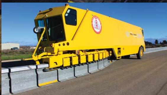
abends eine stadtauswärts. Dabei hebt der Zipper die Betonelemente leicht an und bewegt sie mit einer Art Förderband bis zum Absetzpunkt. Die Versetzbreite beträgt zwischen 1,2 und 5,5 Meter. Für das Versetzen von 2.800 dieser Betonwände benötigt der Zipper rund 30 Minuten. Ein Kranwagen würde mehrere Tage dafür brauchen. Inzwischen wird der 15 Meter lange Road Zipper auch auf europäischen Straßen eingesetzt.
