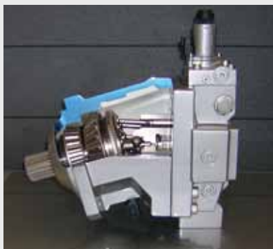
... uložení centrálního čepu hydraulických čerpadel
