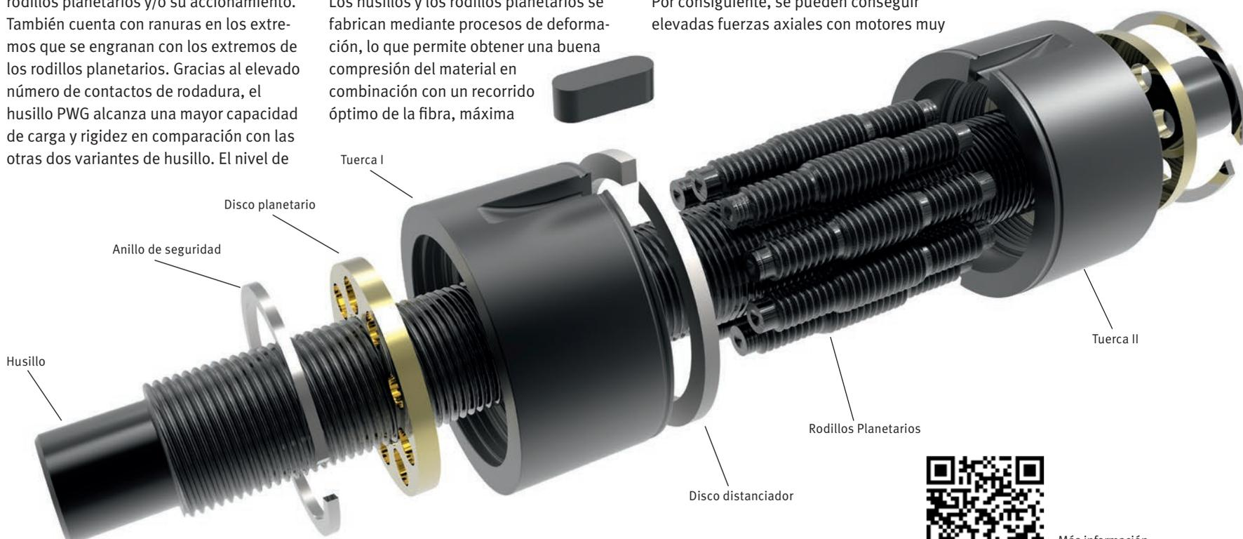
Diseño del husillo planetario PWG: el husillo y los rodillos planetarios se fabrican mediante métodos de deformación.
