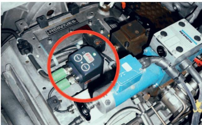
FAG SmartCheck를 사용한 기어박스 모니터링 시스템
