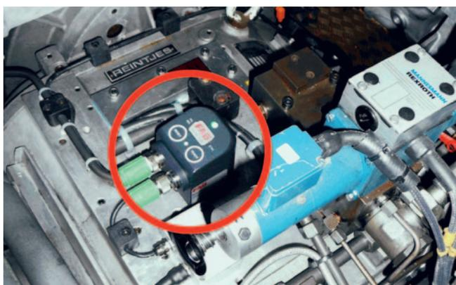
Monitorización de la transmisión de potencia con FAG SmartCheck
