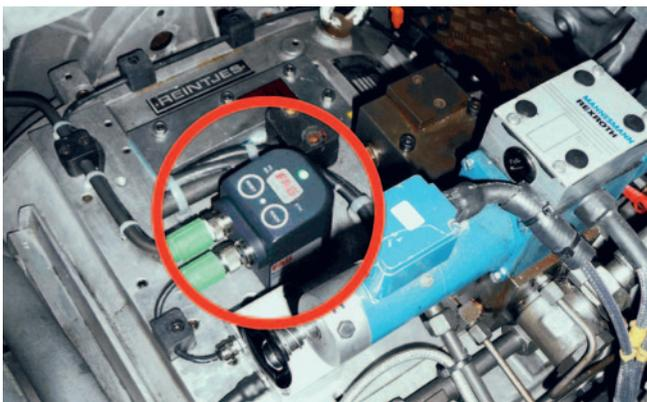
Getriebeüberwachung mit dem FAG SmartCheck
