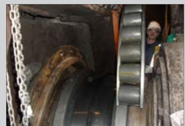
Montaje del rodamiento partido oscilante de rodillos FAG
