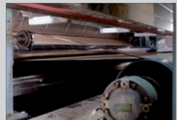
Los rodillos extensores permiten el guiado sin arrugas de las mallas de material
