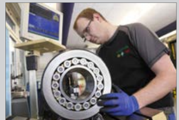
Inspección de los rodillos de apoyo
