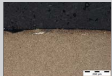
Grietas por fatiga bajo la superficie (WEC) de la pista de rodadura
