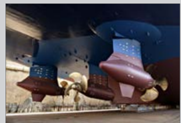
Los sistemas de propulsión Azipod® de ABB están probados y establecidos en los buques para cruceros
