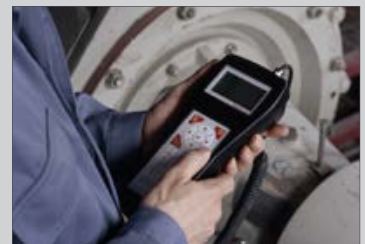
Dispositivo de medición para la monitorización de vibraciones offline FAG Detector III
