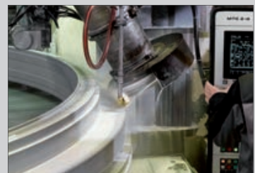
Rectificado de las pistas de rodadura
