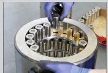
Montaje de los rodillos de apoyo
