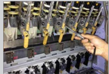
Prueba manual de vibraciones en las unidades de texturización con husillos de fricción
