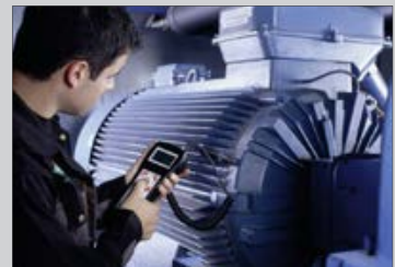
El FAG Detector III puede utilizarse para monitorizar bombas y compresores entre otros componentes
