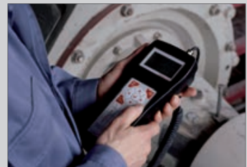
Dispositivo de medición de vibraciones FAG Detector III
