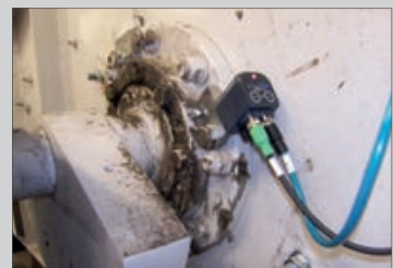
FAG SmartCheck en uso en una criba vibratoria
