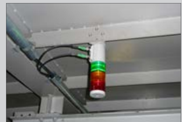
Visualización sencilla del estado en funcionamiento con la ayuda de FAG SmartLamp
