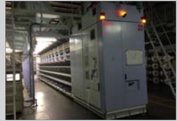
Máquina texturizadora con husillos de fricción de INA
