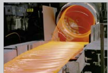
Se da forma al alambre rojo por el calor
