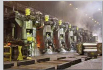
Laminador en caliente de ThyssenKrupp
