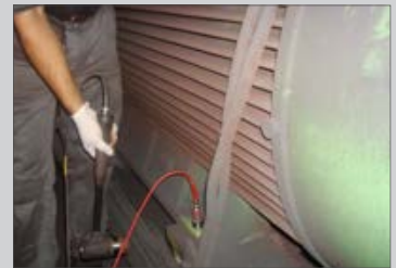
Posiciones del sensor en la bancada del motor para la prueba de impacto
