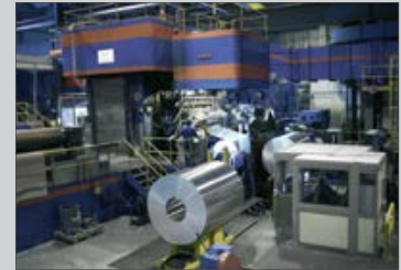
Caja cuarto de laminación en frío
