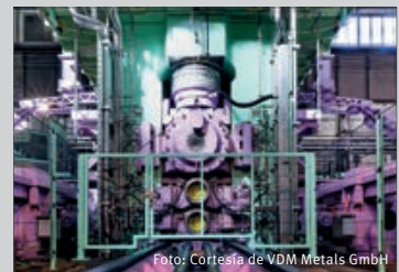
Vista lateral de la caja cuarto
