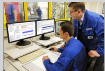
El sistema SCADA visualiza los datos de vibraciones y la información del estado de los sensores en tiempo real
