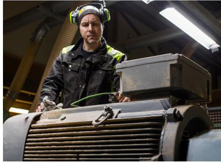
Inbetriebnahme des SmartChecks am Hauptmotor
