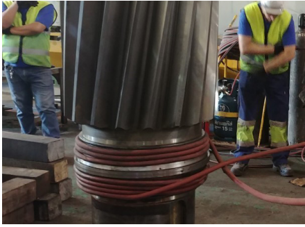
Lagerdemontage durch Anwärmen des verbleibenden Lagerinnenrings auf der Welle
