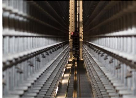
Die Hub- und Fahrtriebe der Regalbediengeräte werden permanent mit Schaeffler SmartCheck-Geräten überwacht
