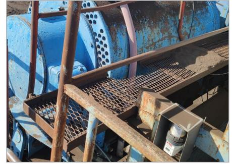
Schaeffler CONCEPT2 im Schutzkasten am Antriebsmotor
