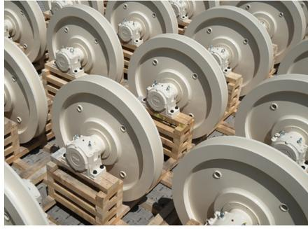
Seilrollen mit FAG Stehlagergehäusen und innenliegendem Pendelrollenlager
