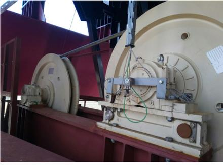
Eingebaute Seilrollen in der Förderanlage mit SNS-Gehäuse und Pendelrollenlager
