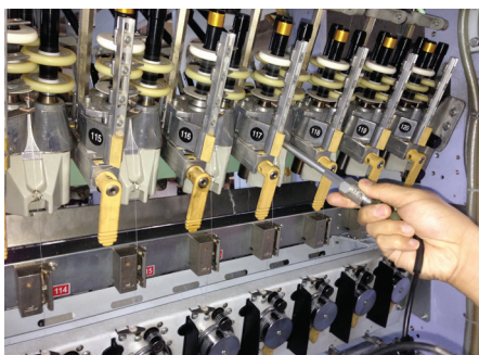
Prueba manual de vibraciones en las unidades de texturización con husillos de fricción
