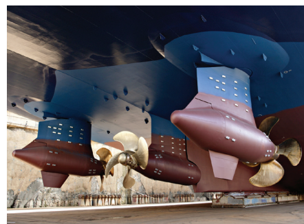
Los sistemas de propulsión Azipod® de ABB están probados y establecidos en los buques para cruceros
