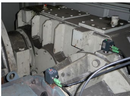
Monitorización del motor y el engranaje mediante FAG SmartCheck
