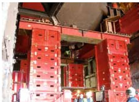
Опорная конструкция конвертера
