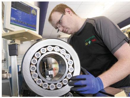
Inspección de los rodillos de apoyo
