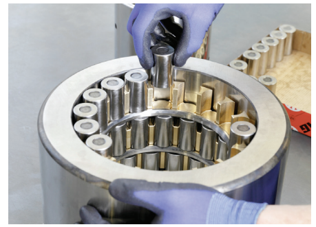
Montaje de los rodillos de apoyo
