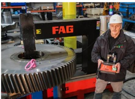
Comparación de tamaños: FAG HEATER5000, el dispositivo de calentamiento más grande jamás construido por Schaeffler junto al FAG HEATER10
