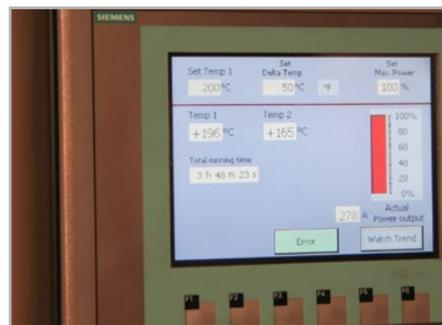
El proceso de calentamiento se controla mediante una pantalla táctil en el FAG Heater5000
