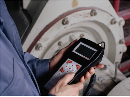
Dispositivo de medición para la monitorización de vibraciones offline FAG Detektor III
