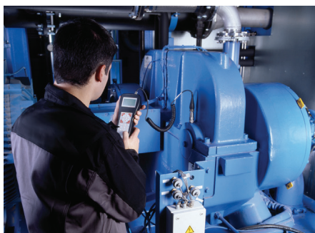
El FAG Detector III puede utilizarse para monitorizar bombas y compresores entre otros componentes
