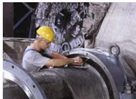
Обработка поверхности на опорной шейке вала
