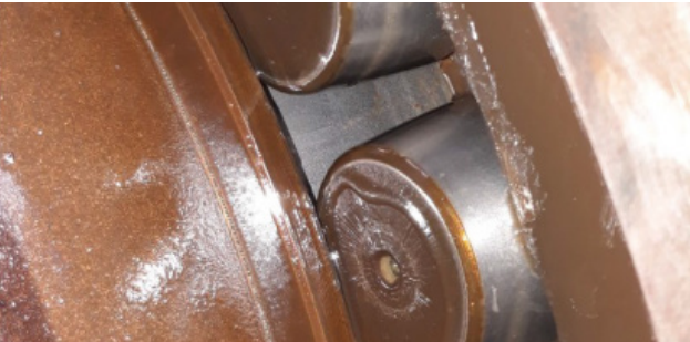
Abbildung 3: Korrosionsmarken am Loslager
