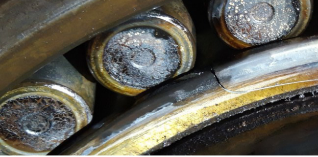
Abbildung 5: Festlager ist am Innenring gerissen
