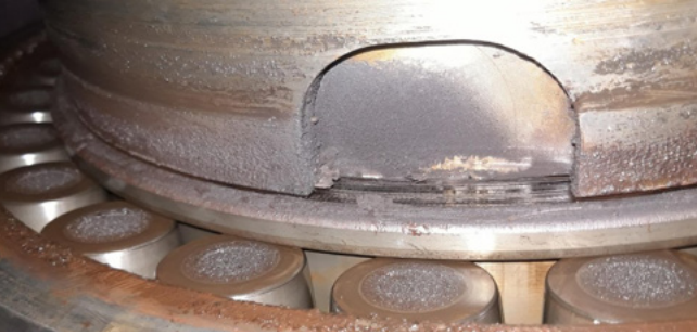
Abbildung 6: Deutliche Gebrauchsspuren des sich drehenden Innenringes
