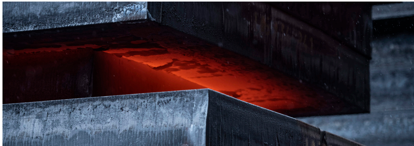
Die massiven Stahlblöcke, sogenannte Brammen, sind Ausgangspunkt für die Herstellung verschiedener Stahlprodukte, insbesondere für Flachprodukte wie Bleche und Platten. Kammwalzgetriebe werden dazu als Teil des Antriebsmechanismus in Walzwerken eingesetzt.
