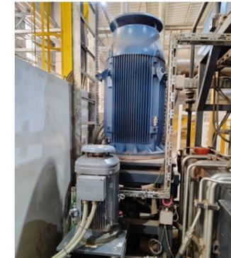
SmartCheck Sensoren überwachen die Hochdruckpumpe der Presse
