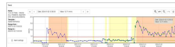
Geschwindigkeitsanstieg im SmartWeb des Getriebes visualisiert
