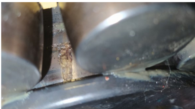
Lagerschaden im Innenring
